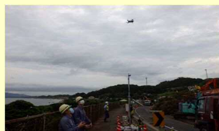
ドローンによる被災箇所撮影
