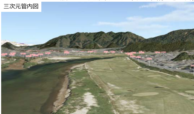
▼航空レーザ測深データ(オルソ画像・地盤高)
