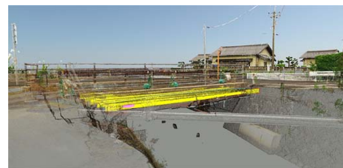
点群データと主桁3Dモデルの合成データで損傷箇所確認
