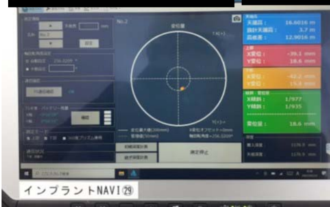
鋼矢板圧入精度計測モニター
