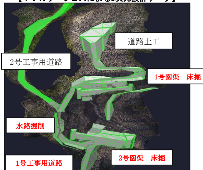
【TINサーフェスによる3次元設計データ】
