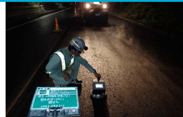
舗装密度測定器を利用した密度確認
