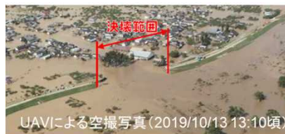
図-2 越水による決壊(千曲川)
