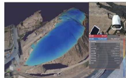
UAVによる掘削土量確認
