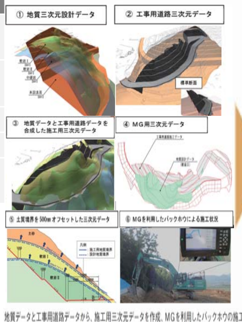
地質データと工事用道路データから、施工用三次元データを作成、MGを利用したバックホウの施工
