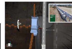
ガードレール設置位置の検討 → 最小作業スペース及び踏破最大幅確保
