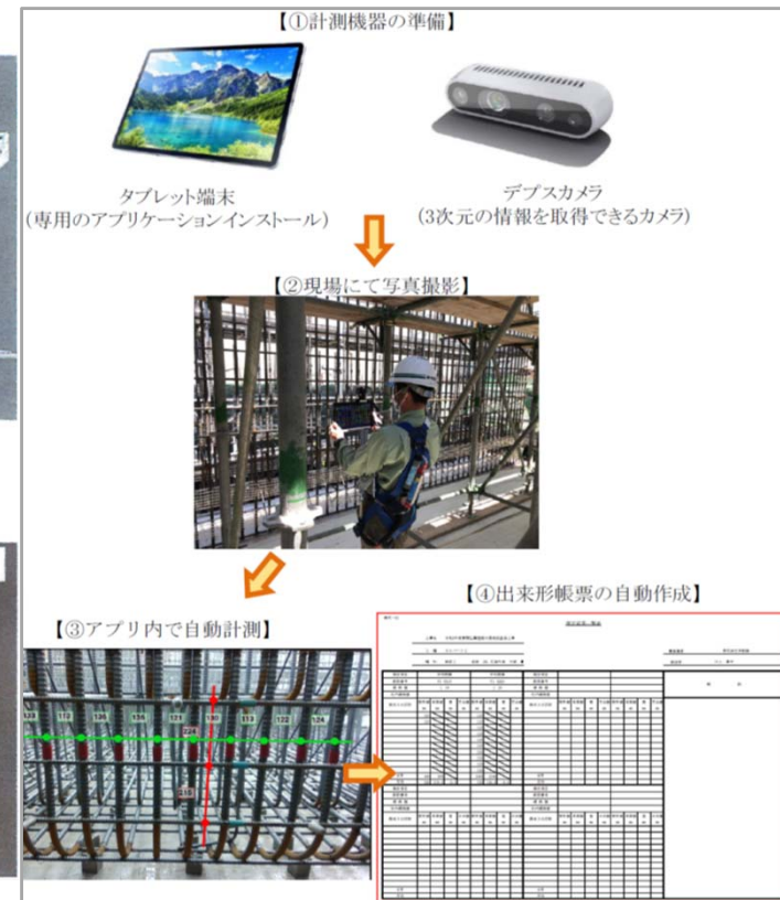
【デジタルデータを活用した鉄筋出来形計測】
