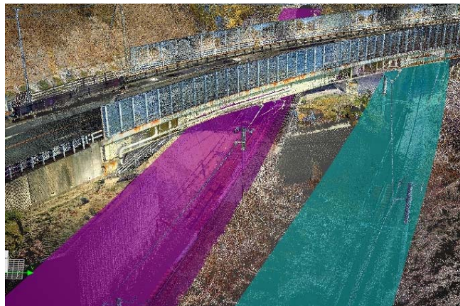
鉄道の建築限界を表示した3Dモデル
