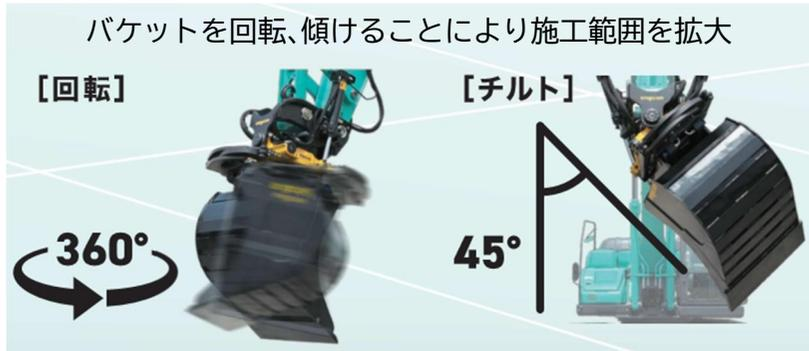
これまでバックホウで掘削できなかった箇所(人力作業)でもバケット向きを変えられるため、掘削が可能となった。
