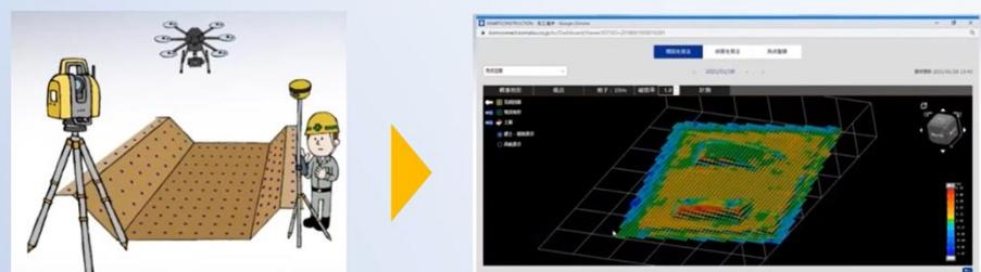
UAV等で計測した後は、計測データを専用のソフトウェアで点群データに処理し、3次元設計データと比較して出来形の確認を行います。
