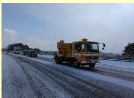
凍結防止剤散布 (山口県宇部市)
