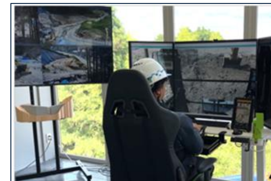
遠隔操縦機械による操作状況
