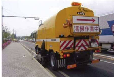
▲ 路面清掃車による路面清掃
