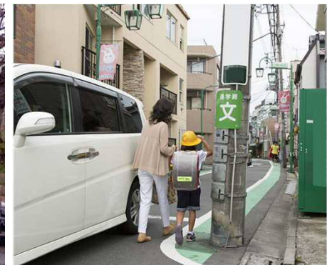
<歩行の支障となる電柱の事例>
