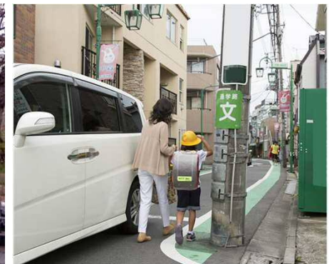
<歩行の支障となる電柱の事例>
