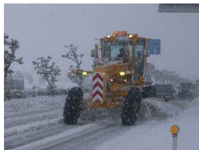
▲ 除雪グレーダによる除雪作業
