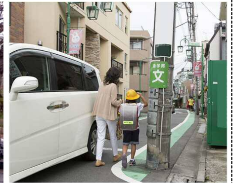
<歩行の支障となる電柱の事例>
