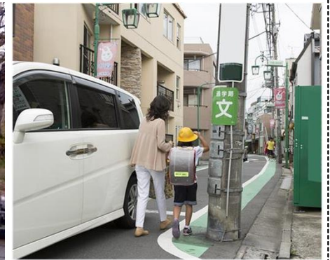
<歩行の支障となる電柱の事例>
