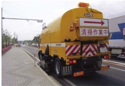
▲ 路面清掃車による路面清掃
