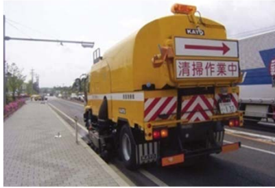
▲ 路面清掃車による路面清掃
