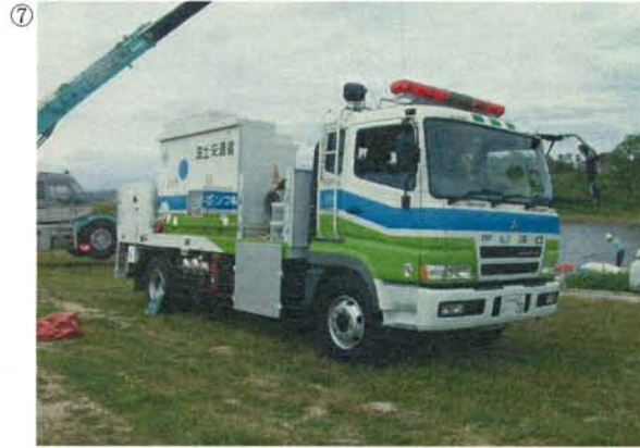
⑦ 名称 : 排水ポンプ車 規格 : 150m 3 /min 目的 : 排水ポンプ車は、内水被害等が発生した場合、速やかに現場に急行し、排水作業を迅速かつ効率的に行えるよう、発動発電機・排水ポンプを1台の車両に架装している。
