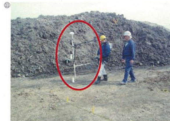
⑪ 名称 : 埋設物探査装置 規格 : - 目的 : 土砂災害現場で復旧作業の前作業として、埋設された金属品（ガスボンベ・車両等）の探査を行う。
