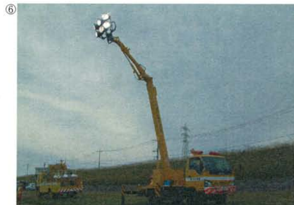
⑥ 名称：照明車 規格：2kW×6灯 25kVA 屈折ブーム式
