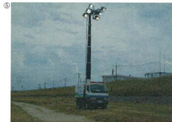
⑤ 名称：照明車 規格：2kW×6灯 20kVA
