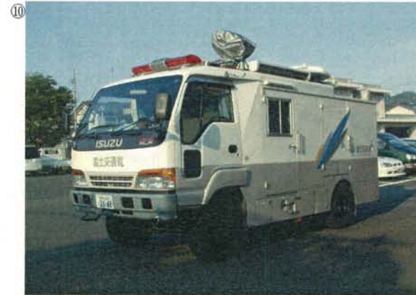
⑩ 名称 : 衛星通信車 規格 : 中型 4×4 目的 : 通信衛星を介して、国土交通省専用の地上多重無線回線を経由することにより、災害現場から各工事事務所へ画像伝送、FAX、電話連絡等の通信を行う。
