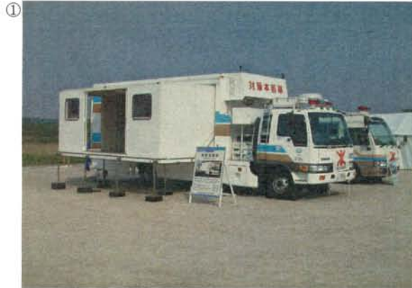
① 名称：対策本部車 規格：車体拡幅型 目的： 大規模な災害が発生した際に、被災現場近隣に出動し、現地対策本部や通信拠点とした復旧支援を行う。 拡幅した場合約10畳の室内が確保できる。拡幅作業は2人でいき、30分程度で完了する。 装備は各種通信装置のほかエアコン・トイレ・シャワー等を有している。
