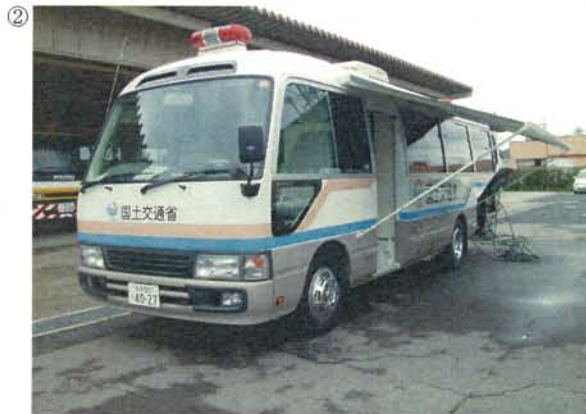
② 名称：待機支援車 規格：バス型 8人乗 目的： 災害対策が長期に渡る場合に派遣作業員の休憩・仮眠施設として使用する。 仮眠を行うためのベットが8人分あり、現場・災害対策本部及び支部間の情報通信を円滑に行うため、衛星携帯電話・(FAX)・パソコン等が装備されている。また、簡易な調理器具も装備している。
