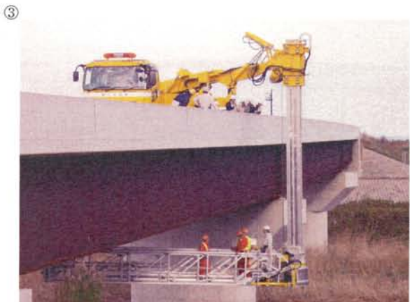
③ 名称：橋梁点検車 規格：歩廊式 目的： 橋梁点検車は橋梁の健全度の点検及び橋梁補修に使用する。
