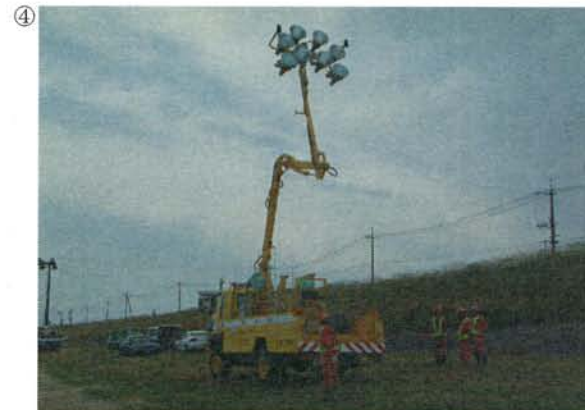
④ 名称：照明車 規格：1kW×8灯 35kVA 目的： 災害が発生した際に、速やかに現地に急行し、復旧作業の夜間照明をはじめ、危険箇所の監視等に使用する。 また、電源供給用として他の機械への電源供給にも使用する。
