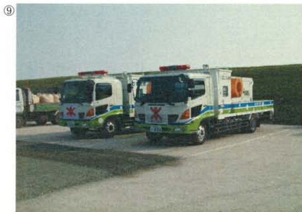
⑨ 名称 : 排水ポンプ車 規格 : 30m 3 /min 超軽量水中ポンプ
