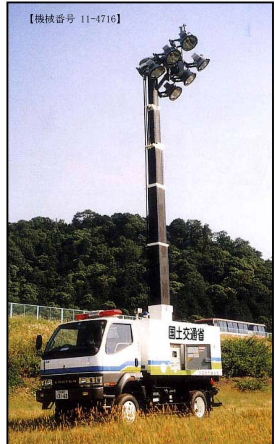
⑦ 照明車(ブーム式) (2kw×6灯)
