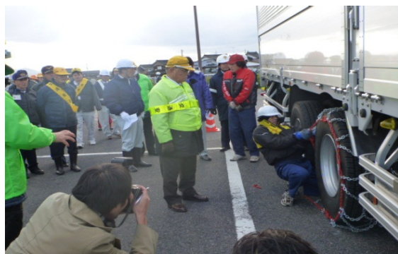
(大型トラックの チェーン装着方法の指導) (鳥取県トラック協会との連携)
