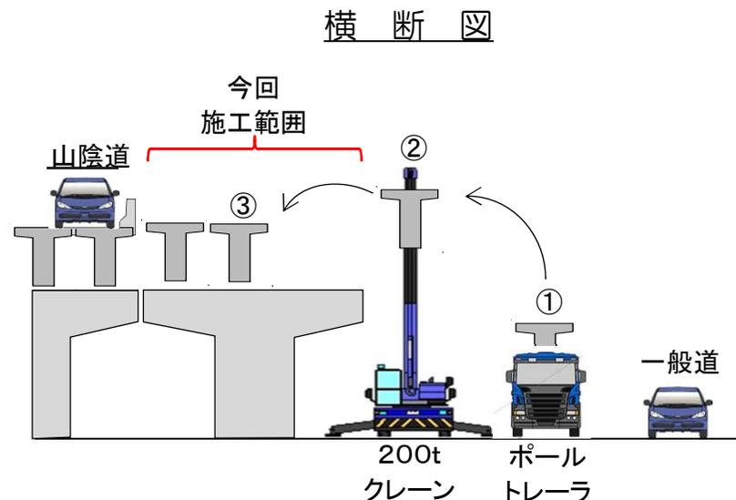
作業の流れ ③橋桁の設置 ← ②200tクレーンで橋桁を吊る ← ①ポールトレーラ搬入
