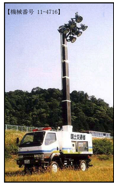
⑤ 照明車(ポール式) (2kw×6灯)
