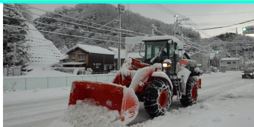
除雪ドーザによる除雪作業 (米子市陰田町)
