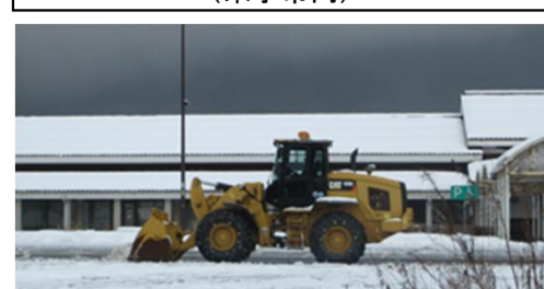
除雪ドーザによる除雪作業 (道の駅「はわい」)
