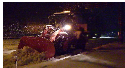
除雪ドーザによる除雪作業 (米子市内)
