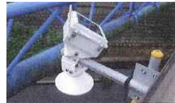
低コスト型水位計の設置例
