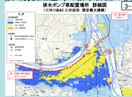
天神川8.4k左岸破堤時の排水ポンプ車配置場所
