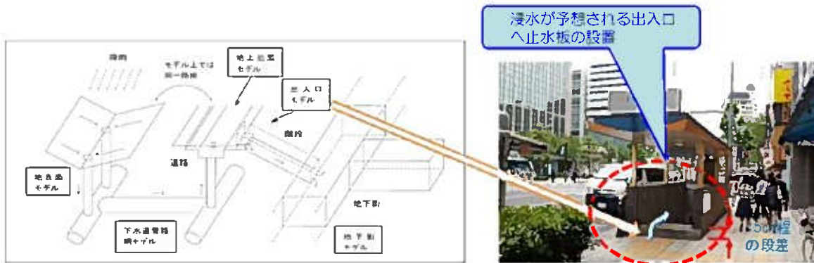
② 浸水シミュレーションにより浸水する出入口の特定と止水板の設置
