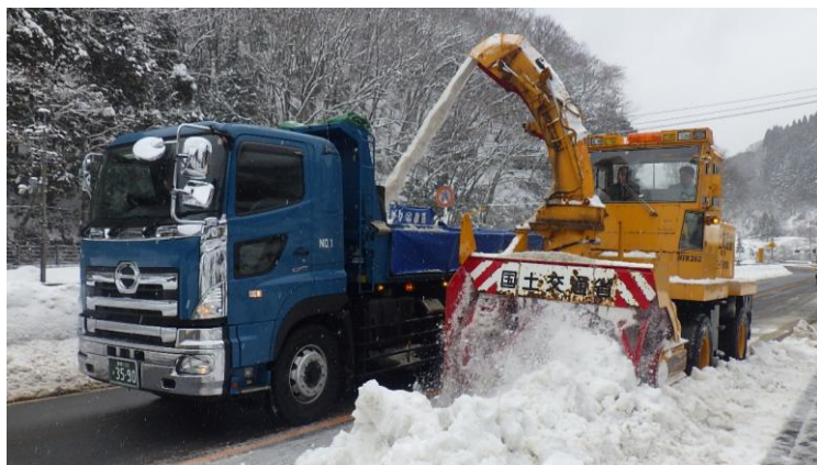
運搬排雪状況(令和2年12月 飯石郡飯南(R54))
