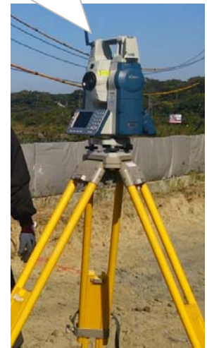
体験予定の自動追尾機能を を搭載した測量機器
