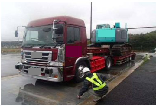
車両寸法計測状況
