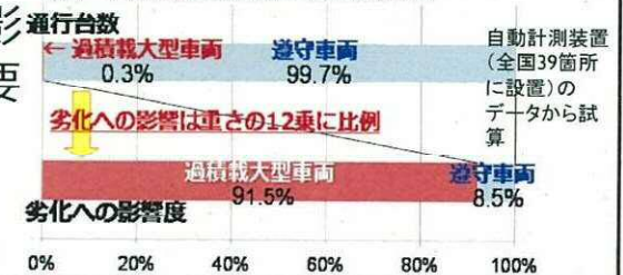
【図 道路橋の劣化に与える影響】
