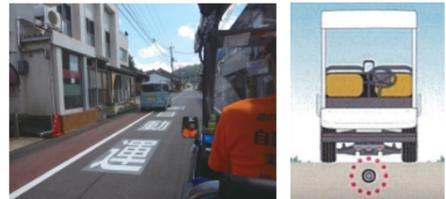
埋設された電磁誘導線に沿って走行しますので、走行ルート上にあるものを障害物として認識し、自動で停止します。電磁誘導線上の路上駐停車にご配慮ください。
