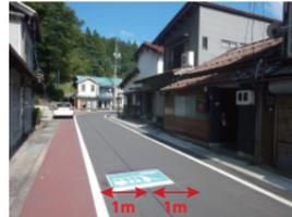
自動運転車両は、道路に埋設されている電磁誘導線をたどって走行します。見通しの悪いカーブでは、ご注意ください。
