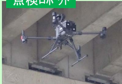
点検ロボット(ドローン)を飛行させ、近接写真を連続で撮影
