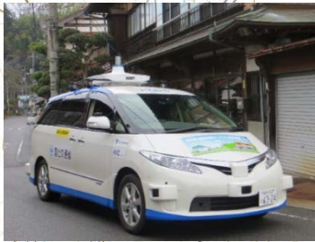
高精度3Dマップを活用した自動運転車両
