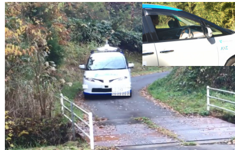
狭隘・急こう配・線形不良・植栽繁茂への対応 (通行止めした専用区間を走行・レベル4(高度運転自動化(運転席無人)))
