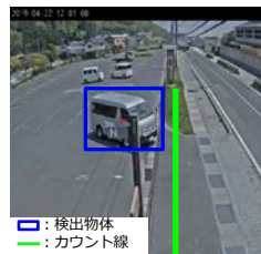
青枠の物体を自動車として検出 緑：カウント線
