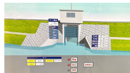
樋門の遠隔操作システムの操作画面
