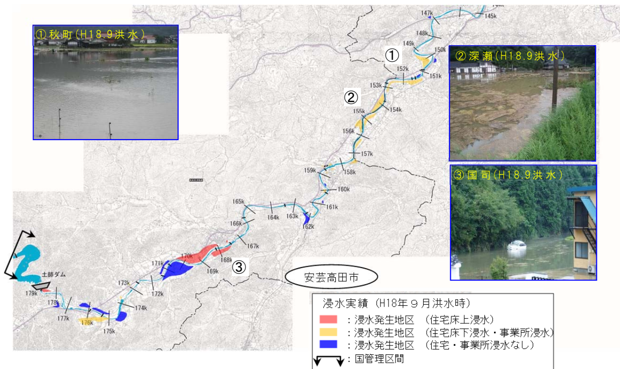
図 2.1.6 平成 18 年 9 月洪水における江の川上流の内水被害
