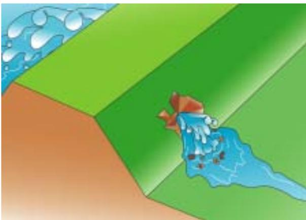
洪水の時、堤防の裏側から水が出て、堤防を危なくします。
