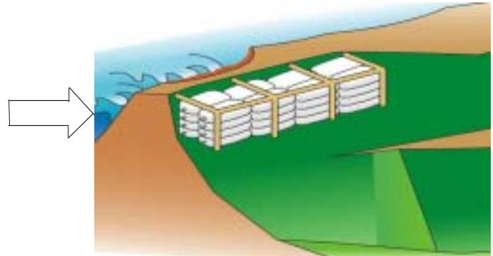
堤防の裏側に土のうを積んで、堤防が壊れないようにします。
