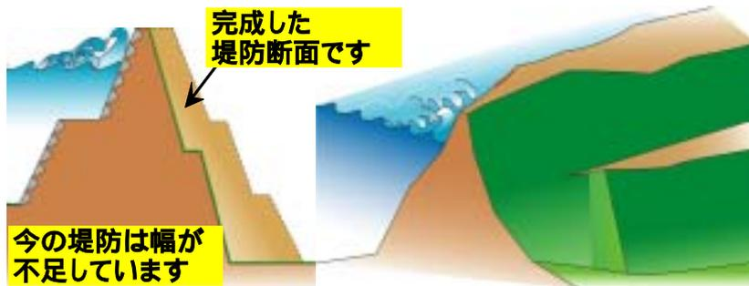
堤防断面が小さいと川の水で堤防が削られ、壊れやすくなります。
