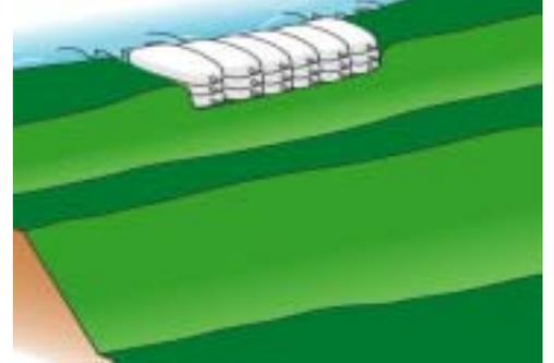
堤防が低いと洪水の時に川の水が溢れます。
