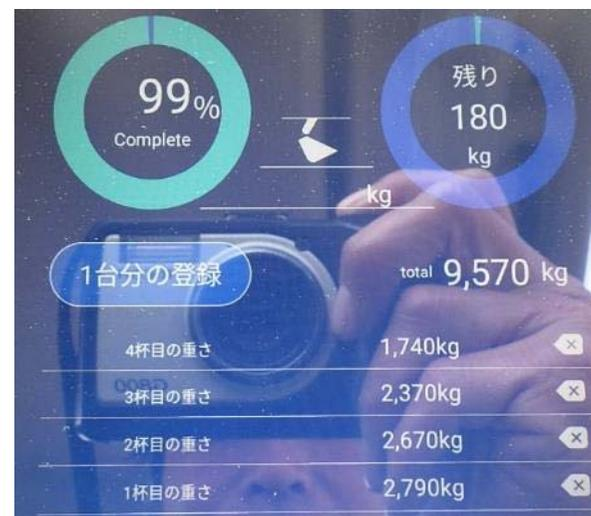
オペレータが運転席のモニターで積載重量を確認
