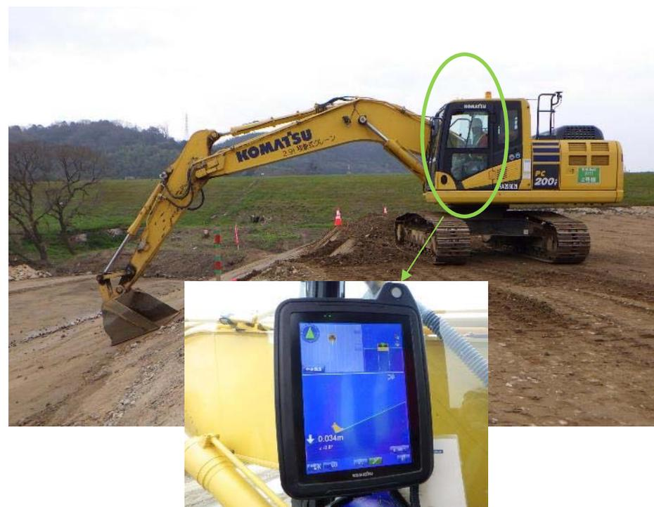
3次元データにより、ICT建設機械を制御し施工
