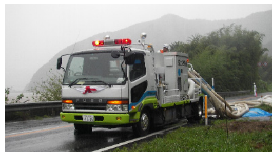
排水ポンプ車の出動状況
