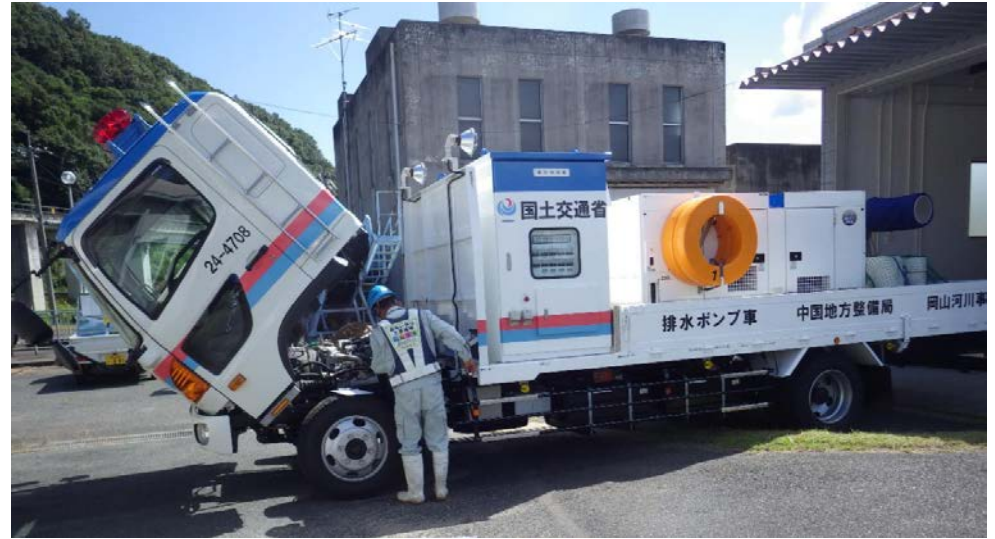
排水ポンプ車の試運転の様子
