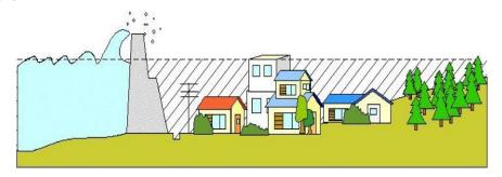
堤防は、高潮の被害を防いでくれていますが、 地震などで堤防が壊れると地盤の低い所では 大きな被害になります。
