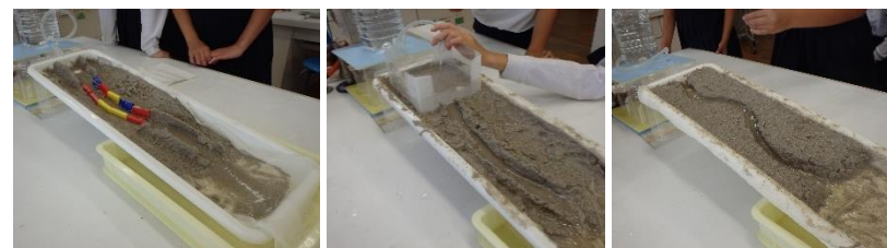
▲ 各班の模型。左から築堤、ダム、河道掘削の模型
