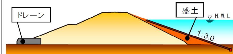
堤防補強(浸透対策)のイメージ図
