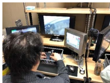
《ICTを活用したトンネル掘削機械の遠隔操作》
