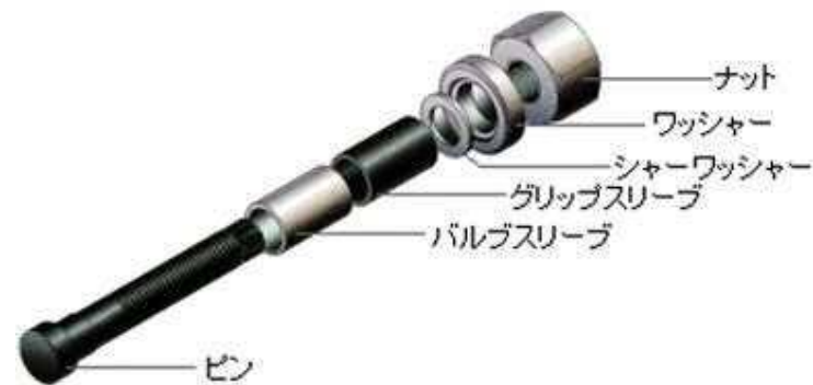
図-1.9 ワンサイドボルト構造概要（株式会社フセラシ ホームページ）
