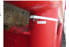
加速度計設置位置 (上弦材)
