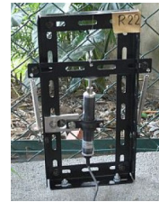
水上部での変位計測方法
