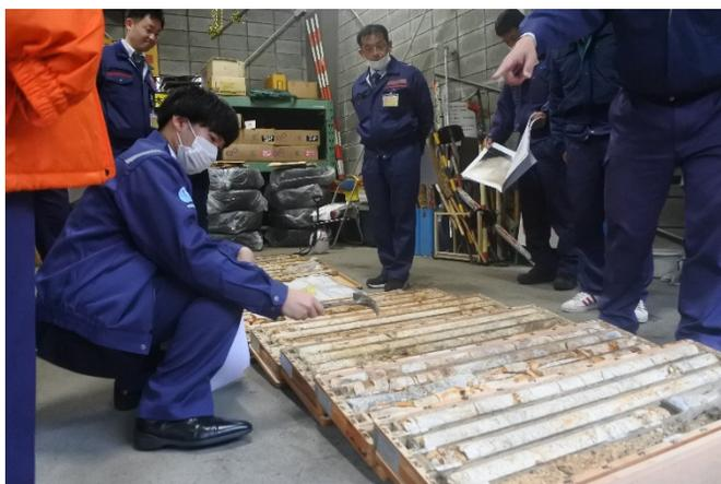
固い石の層はつるつるして、ハンマーで叩いても「コンコン」という音がしていましたが、マサ化した部分では、にぶい音がして表面もザラザラしていました。ハンマーでの叩き方もあるようです。釘を打つときの様に太い方で叩くと割れてしまうので細い方でコンコンと叩いていました。
