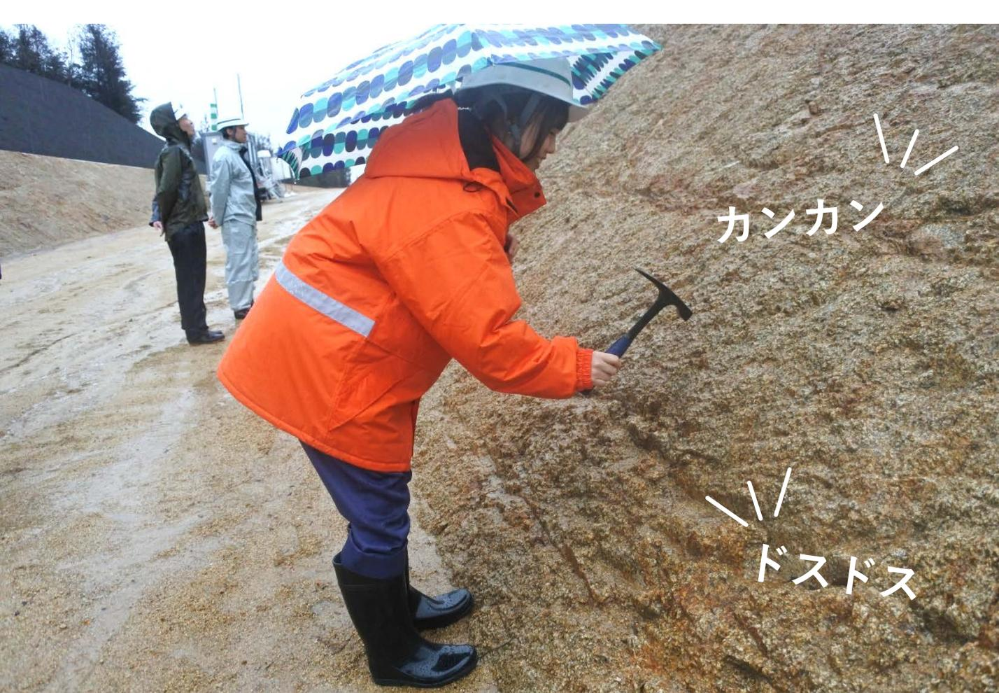
ハンマーで叩いてみると、固い部分は「カンカン」と高い音で固い感触でしたが、柔らかい部分では「ボスンボスン」や「ドスドス」といった音で、感触も土に沈むような感じでした。
