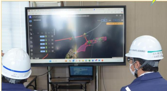
それぞれのダンプトラックの位置情報や稼働状況（移動中、積み込み・荷降ろし等）、施工履歴をリアルタイムで把握することができます。
