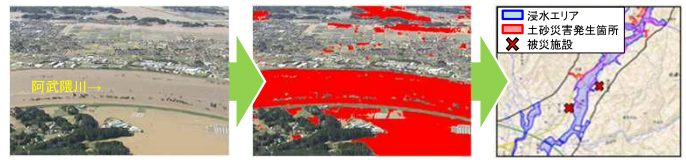
ヘリ映像を用いたAIによる浸水範囲等の自動抽出
