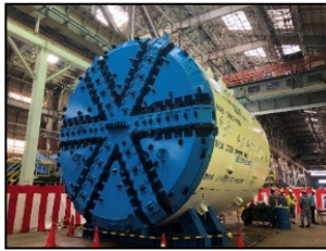
シールドマシン全景 (シールド機外径φ5,900mm) (仕上がり内径φ5,250mm)
