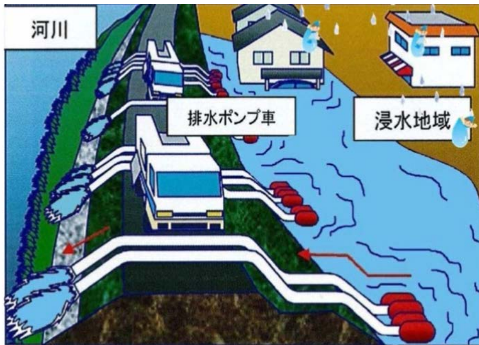
排水ポンプ車による内水排除支援イメージ
