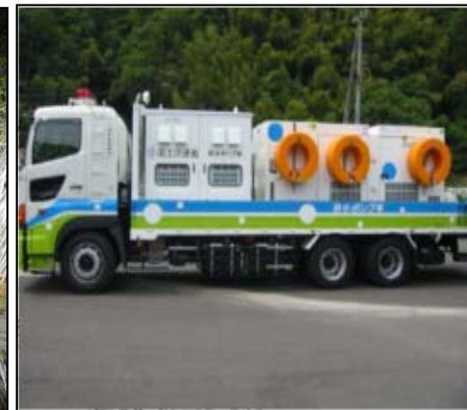
排水ポンプ車
