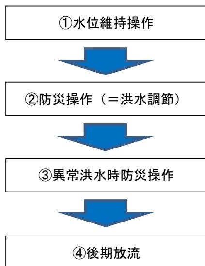
図 2-4 弥栄ダムの防災操作の手順フロー
