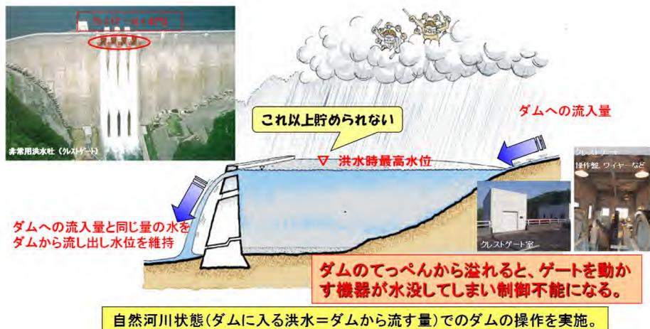
図 2-7 異常洪水時防災操作のイメージ図
